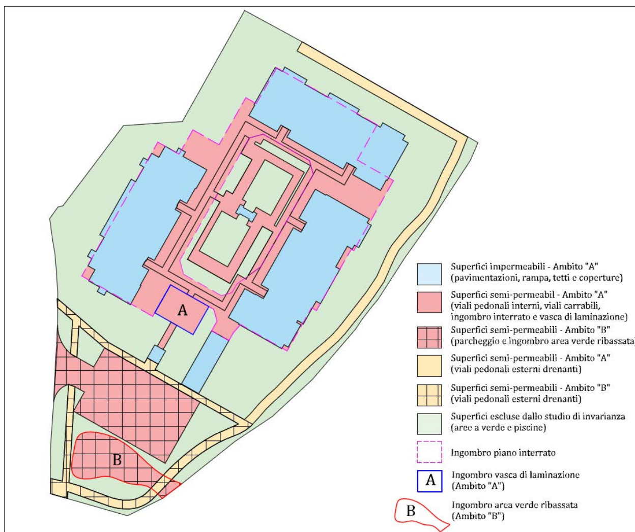
Fig. 8 - Planimetria di progetto con individuazione dei due ambiti considerati e relative superfici di trasformazione, ovvero superfici impermeabili (blu), semi-permeabili (arancio e rosso), quelle escluse dallo studio di invarianza (verde) e dell'ingombro delle opere di invarianza progettuali.
