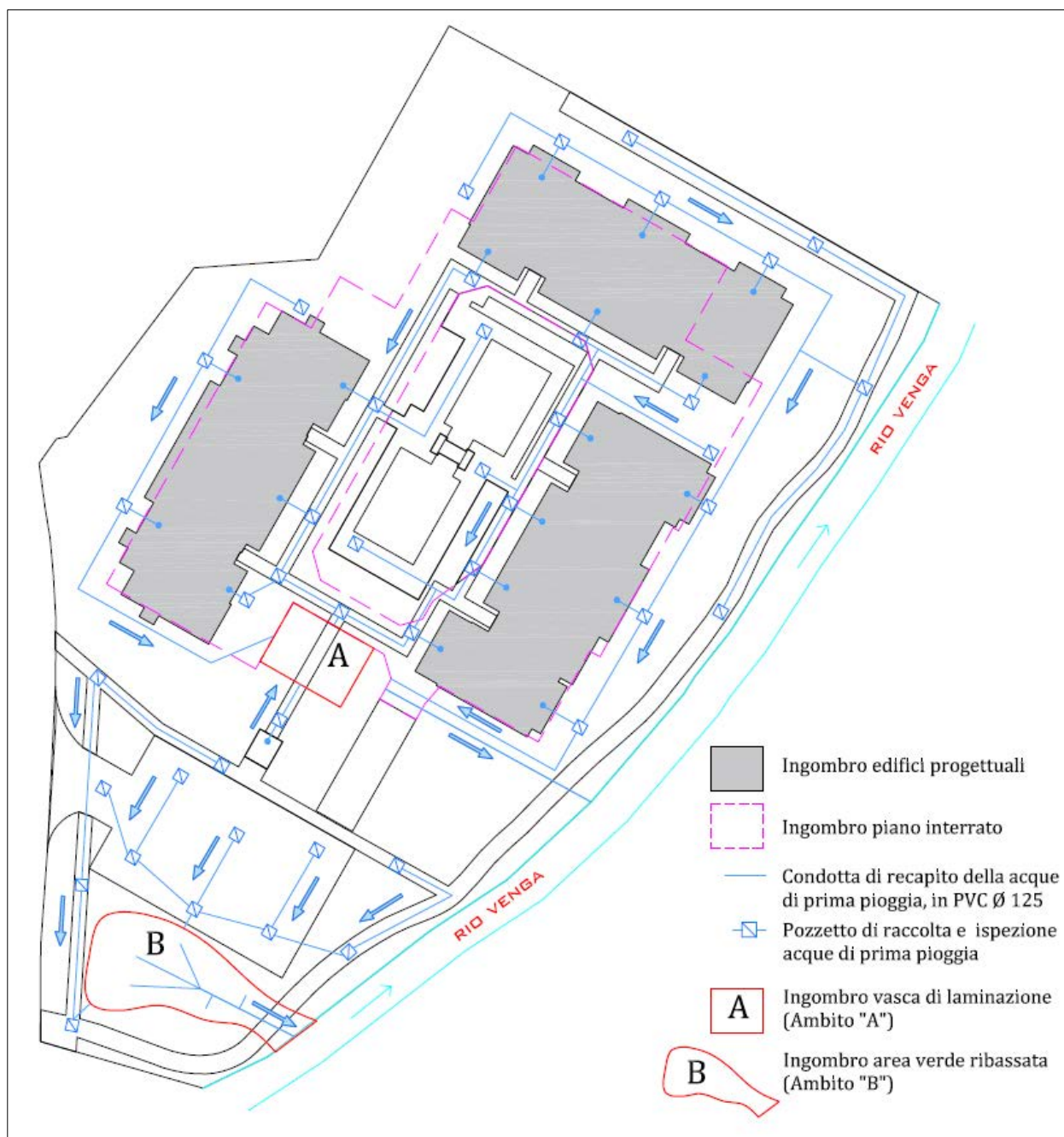
Fig. 11 - Individuazione dei sistemi di laminazione (in rosso), costituiti da una vasca di laminazione (Ambito A) e un'area verde ribassata (Ambito B), conformi allo studio di invarianza idraulica.
