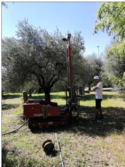
Esecuzione Prova Penetrometrica P6
