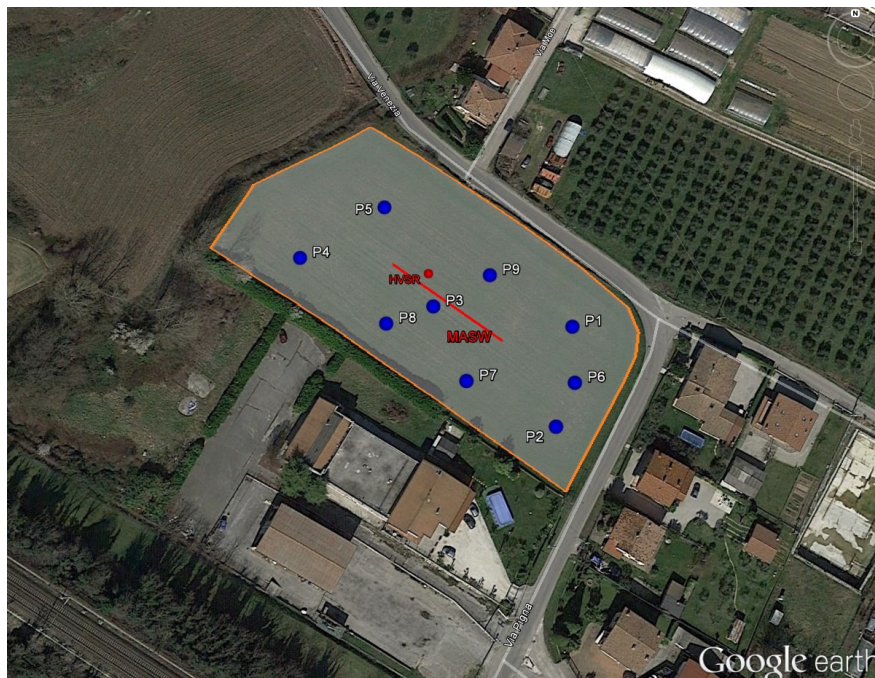
Fig. 6- estratto della Relazione geologica a pag. 12 “Fig. 6 - Planimetria con individuazione del lotto di interesse e con ubicazione dei punti di indagine, su immagine da satellite”
