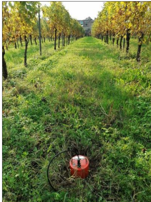
Misura del microtremore sismico mediante tecnica H.V.S.R.
