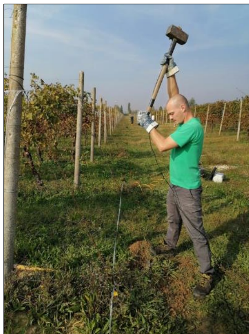
Shot sismico orizzontale per la generazione delle onde di Love
