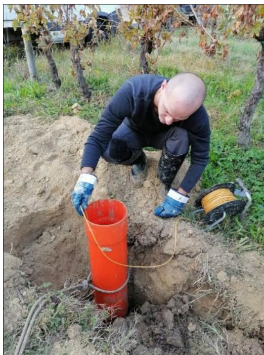
Fig. 7 - Esecuzione di prova di permeabilità in sito.
