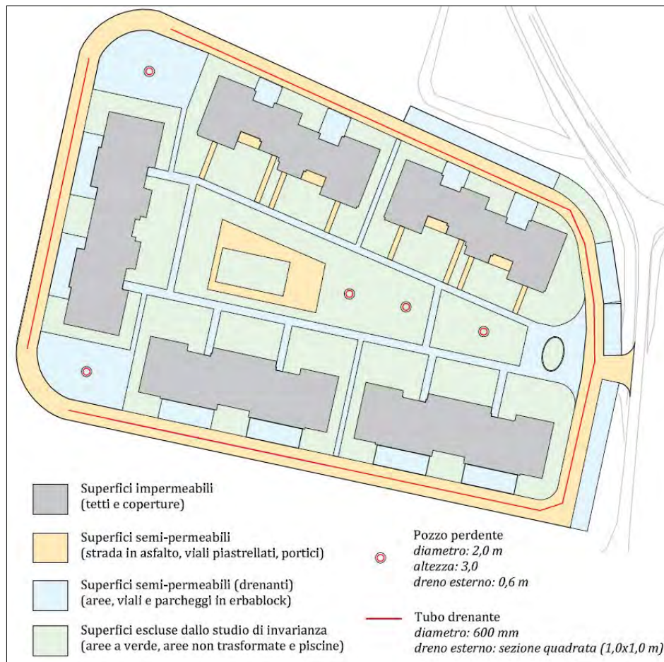
Fig. 8 - Planimetria di progetto con individuazione delle superfici di trasformazione, ovvero superfici impermeabili (grigio), semi-permeabili (arancio e blu), quelle escluse dallo studio di invarianza (verde) e dell'ingombro delle opere di invarianza progettuale.
