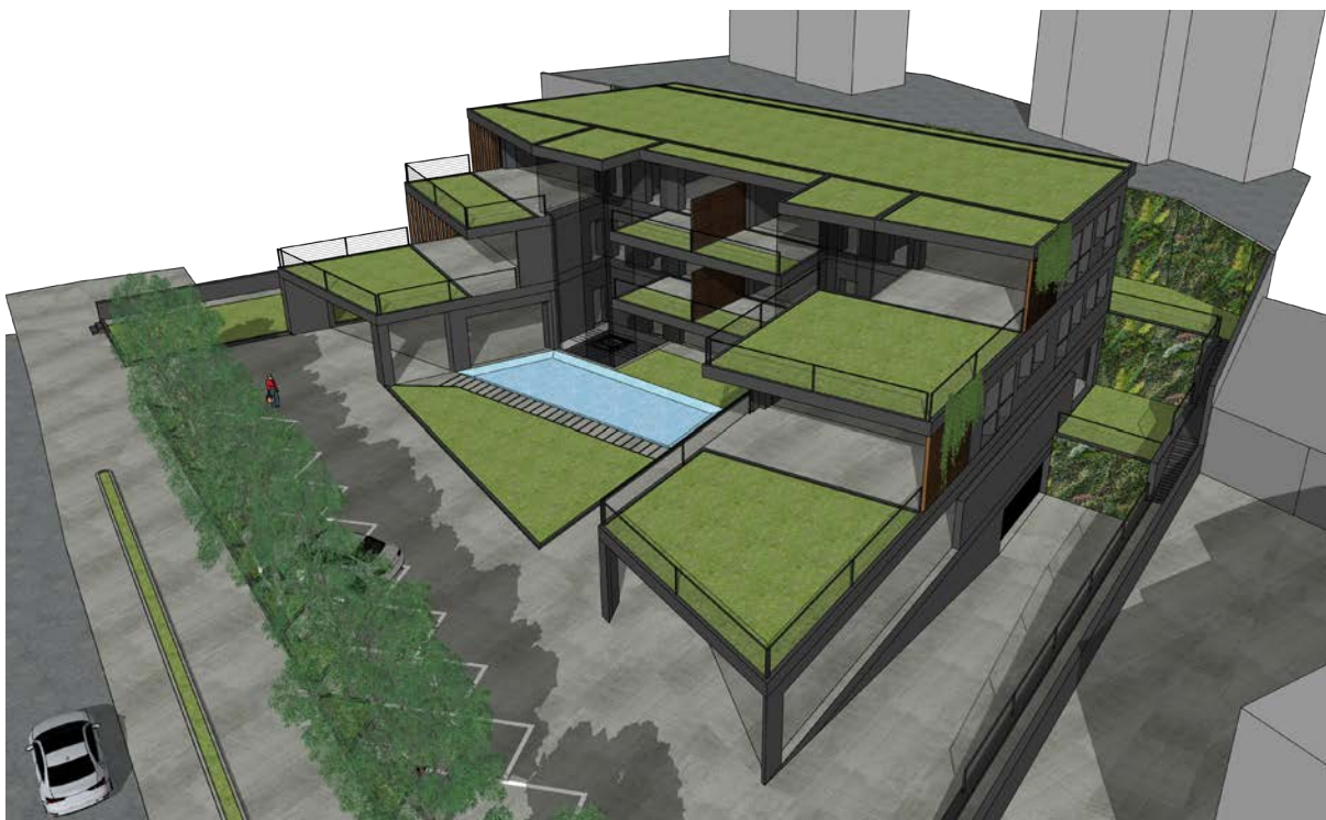
immagine con ripresa da lato nord-est del fabbricato in cui è evidente l'utilizzo del verde pensile per la copertura e le terrazze degli alloggi adibiti a residenza
