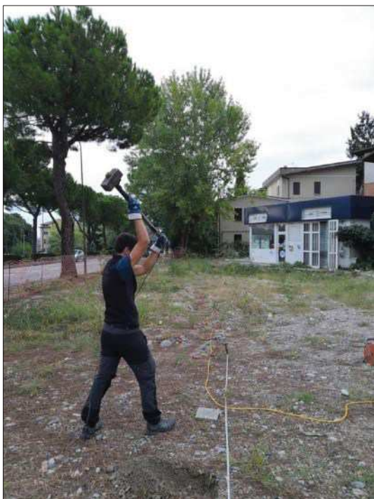
Shot sismico verticale per la generazione delle onde di Rayleigh (Offset 2 m)
