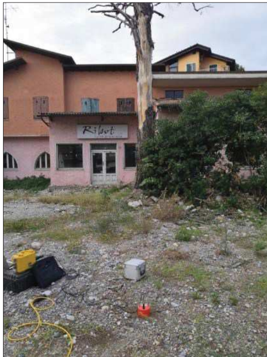
Acquisizione del microtremore sismico mediante tecnica HVSR
